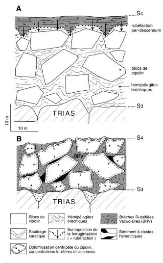
Fig. 4. Surimposition de la paléosurface d'altération S4 et genèse de la brèche de type 2 par altération (rubéfaction) et effondrement-dissolution d'un olistostrome à blocs de cipolin et matrice d'hémipélagites.
