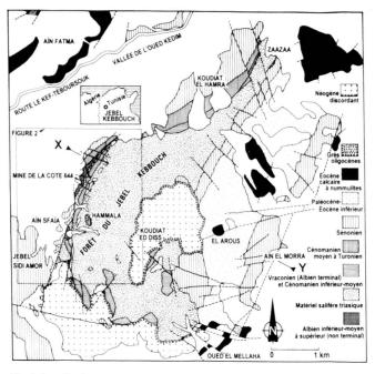
Fig. 1. Localisation schématique (cartouche) et carte géologique simplifiée du J. Kebbouch. Le Quaternaire est en blanc, les fractures en trait fort (supposées en tireté); X-Y: localisation de la coupe interprétative synthétique de la Fig. 5.
