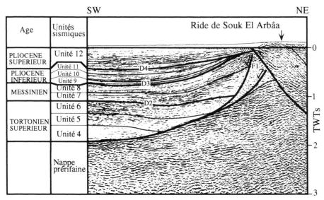
le jeu normal de la faille d'Ouled Merah (F1) attesté par les réflecteurs divergents (unités en dessous de D3) et la compression ultérieure matérialisée par des réflecteurs convergents (unités au dessus de D3).
