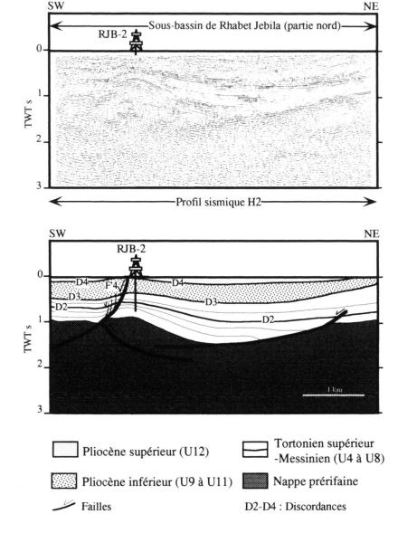
Fig. 8. Section sismique H2 et interprétation (localisation dans la figure 2)
