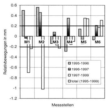
Fig. 10. Geodätisch ermittelte relative Vertikalbewegungen entlang von sechs Störzonen des Untersuchungsgebietes (Messlokalitäten siehe Figur 2). Positive Werte bedeuten entweder ein relative Hebung des Südteils oder eine relative Senkung des Nordteils im jeweils dargestellten Zeitraum. Werte, die ausserhalb des Fehlerbereiches von 2 Standardabweichungen (=0.2 mm, dick ausgezogene Linien) liegen, sind im statistischen Sinne signifikant.
