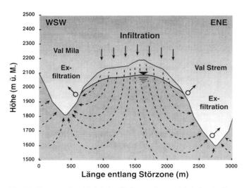
Fig. 17. Konzeptuelles Modell der Tiefengrundwasserzirkulation in Form eines WSW-ENE Profils durch die Alp Caschlè. Die Position des eingezeichneten Bergwasserspiegels richtet sich nach der Lokalität der in der Val Strem und Val Milà beobachteten Ouellaustritte.
