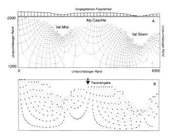
Fig. 18. Resultate der FLOWNET-Modellrechnungen. A: 2D-Fliessnetz entlang des gesättigten Bereichs einer Störzone durch die Eingabestelle von Naphtionat auf Alp Caschlè für konstante und isotrope Durchlässigkeiten. B: Stromlinien und (advektive) Zeitmarken im Abstand von 7.2 Tagen (bzw. 0.02 Jahren).
