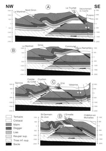
Fig. 5. Profils géologiques présentant la structure de la région de Champfromier et du Nord du plateau du Retord. Le profil C passe par l'ancienne carrière de gypse de Prébasson. Le volume caché isolé par un double jeux de chevauchements permet l'émergence en surface d'unités triasiques et liasiques. FM = faille de Monnetier.
