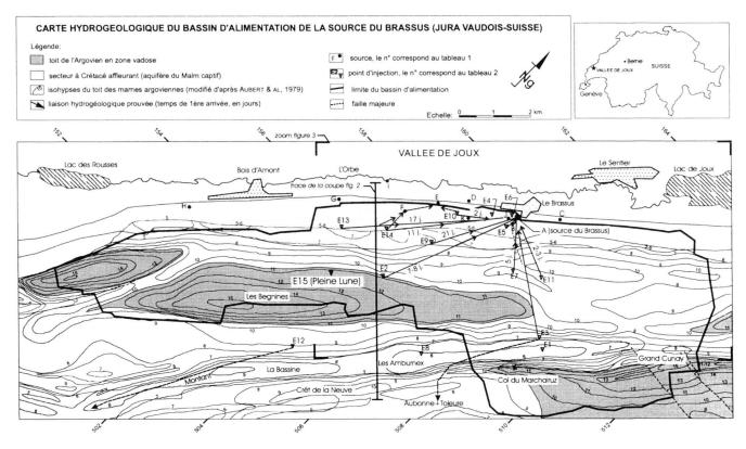
Fig. 1. Bassin d'alimentation de la source du Brassus et isohypses de la base de l'aquifère (marnes de l'Argovien), modifié d'après Aubert et al. (1979). Les limites du bassin sont basées sur la structure géologique, les zones marginales sont englobées dans le bassin dans l'optique d'une protection optimum de la source.
