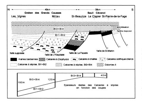
Fig. 8. Reconstitution en coupe du domaine caussenard le long d'un transect Nord-Sud, des Vignes (Gorges du Tarn) à Saint-Pierre-de-la-Fage (Seuil Cévenol). Ce dessin est sans échelle pour montrer la réalité des dépôts bathoniens selon un système de blocs basculés incluant des dépôts *syn-rifts* recouverts par les dépôts *post-rifts*.
