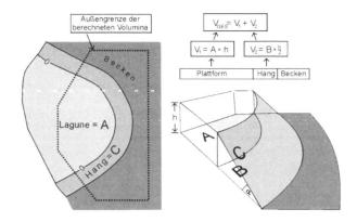
Fig. 13. Parameter und Formeln für die Berechnung des Plattformvolumens (A – Lagunenfläche; C- Hangoberfläche; B – Projektionsfläche unterhalb der Hangoberfläche; h – Höhe der Plattform;  $\alpha$  – Hangwinkel).
