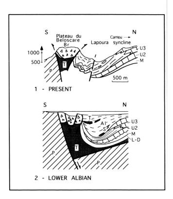
Fig. 4. La structure diapirique de Béloscare (D3, Fig. 1). P: Paléozoïque; T: Trias; L-D: Lias et Dogger; M: Malm; U2: Gargasien; U3: Clansayésien; Al: Albien; Br: brèches d'Etchebar (dissolution et collapse); S: slumps.
