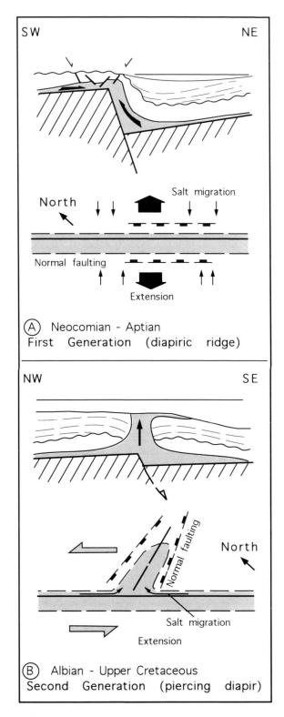
Fig. 8. Modèle de création des structures diapiriques. A: création des rides NW-SE de première génération sous l'effet d'une distension NE-SW. B - création des diapirs perçants, de deuxième génération, par transtension avec composante en décrochement W-E sénestre le long des failles W-E et jeu normal des failles NE-SW.
