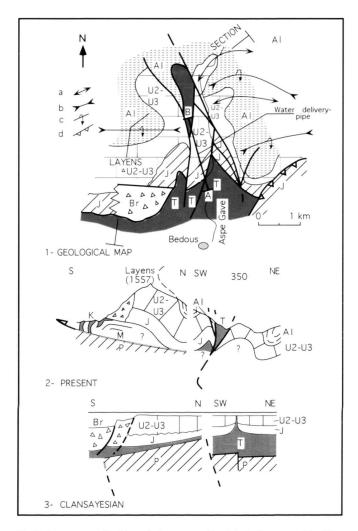
Fig. 9. La structure diapirique du Layens, au Nord de Bedous, en vallée d'Aspe (voir localisation précise sur la figure 1).
