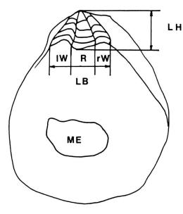
Fig. 1. Bei den Ostreidae verwendete Begriffe: LH Ligamenthöhe, LB Liganentbreite, R Resilifer, lW linker Wulst, rW rechter Wulst, ME Schliessmusteleindruck
