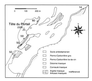
Fig. 10. Carte géologique de la région Tête du Portail-Portail de Fully. Le coeur du synclinal est constitué de dolomies et cornieules. Les limites entre ces dernières sont quelque peu arbitraires puisque les dolomies peuvent être transformées en cornieules suite à une intense fracturation.
