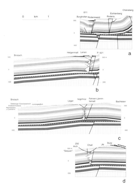
Fig. 8. Profile durch den Halbgraben von Lenen-Roderisweid. Kreuzschraffur = mutmassliche tektonisierte Zone der Lenenchöpfli-Transferzone. Für die Profilspuren s. Fig. 2 und 5, für die mesozoische Schichtfolge s. Fig. 9, für das Tertiär s. Fig. 4.
