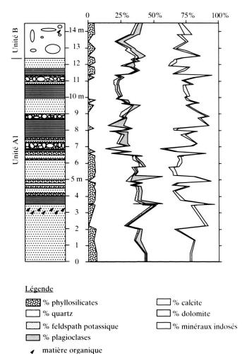
Fig. 3. Coupe des Breguettes: distribution des minéraux de la roche totale, exprimé en pourcentages.
