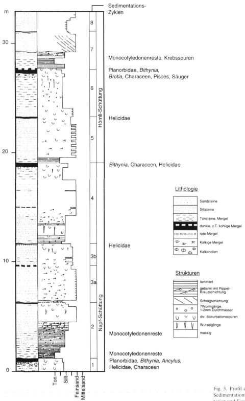
Fig. 3. Profil der Mergelgrube Hochdorf mit Angabe von Sedimentationszyklen, lithologisch-sedimentologischen Kriterien und Fossilinhalt.
