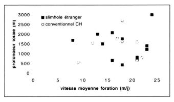
Fig. 3. Vitesse moyenne d'approfondissement de forages géothermiques: comparaison entre des forages slimhole carottés, réalisés dans divers pays, et huit forages rotary conventionnels en Suisse (Flynn et al. 1994; Goff S. (ed.) 1992; Goff S. et al. 1988; Gunn 1991; Kato & Kizaki 1993; Lysne & Jacobson 1990; Office fédéral de l'énergie 1995; Olson & Deymonaz 1993; Vuataz F.D. 1987).
