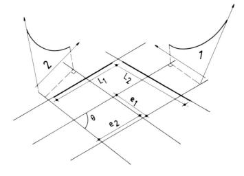
Fig. 5. Intersection entre deux familles de discontinuités. La condition est que la persistance L<sub>1</sub> de la famille 1 soit supérieure ou égale au double de l'espacement e<sub>2</sub> de la famille 2 et réciproquement. Est considérée la persistance moyenne par famille, tandis que les espacements obéissent à une loi de répartition évoquée par les courbes suivant un axe vertical (modifié d'après Jaboyedoff et al. 1996)
