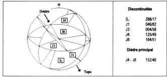
Fig. 4. Stéréogramme Schmidt-Lambert (hémisphère supérieur) des discontinuités. On y relève le mécanisme de mobilisation principal, à savoir *glissement profond potentiel vers le SE sur dièdre généré par J4 et J8*.
