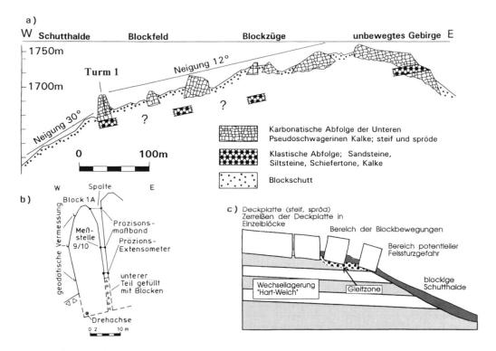
Fig. 8. Bergzerreissung Tressdorfer Höhe/Kärnten.
