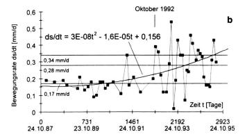
Fig. 9. a) Gesamtöffnungsbeträge an der Messstelle 9/10 (zur Lage s. Fig. 8) des Felsturmes und b) die täglichen Verschiebungsbeträge gemittelt über eine Periode von 28 Tagen für die Zeit von Okt 87 bis Okt. 95 (n. Glawe & Lotter 1996)
