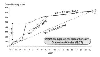
Fig. 6. Bewegungsgeschwindigkeit an der Talzuschubsstirn des Talzuschubes Gradenbach/Kärnten von 1972 bis 1990. Deutlich ist zu ersehen, dass die Prognose für sachgerechte Verbauungsmassnahmen und Sanierungskonzepte oft nicht aus gemittelten Werten nur einer kurzen Messperiode abgeleitet werden kann.
