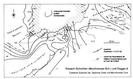
Fig. 11. Isopachenkarte des «Dogger  $\beta$ », der Sissach- und der Murchisonae-Schichten. Zusätzlich dargestellt sind – soweit bekannt – die Isolinien des Maximalwerts der mittleren Quarzkorngrösse am Top der Einheit.
