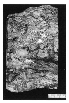
Fig. 4. Event-Bed: (Sehr) gut gerundete Sandsteinklasten in einer Matrix aus tonflaserigem Sandstein. Einige der Klasten sind randlich verfärbt (Oxidationssäume?). Trotz der Verwühlung lässt sich eine leichte Gradierung erkennen. Horizont Her D<sub>1</sub>, Bohrung Herdern-1, 1712,35 m. Gesägte Probe.
