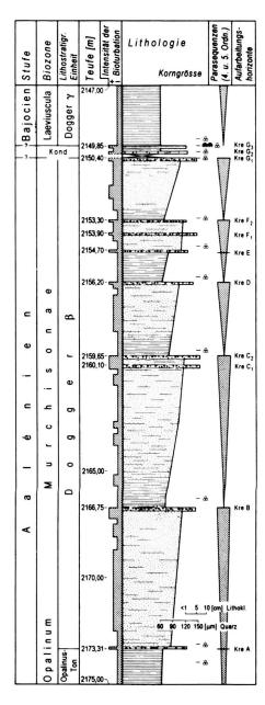
Fig. 8. Detailprofil «Dogger  $\beta$ », Bohrung Kreuzlingen-1 (Legende siehe Fig. 6).
