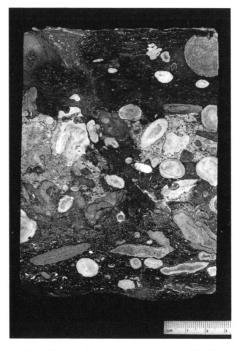
Fig. 5. Hartgrund am Top des Kondensationshorizonts Her D<sub>3</sub>, bestehend aus einer bis 3,5 cm dicken, diskontinuierlichen Lage aus leicht sandigem, eisenoolithischem Mikrit mit Lithoklasten. Bohrung Herdern-1, 1711,43 m.
