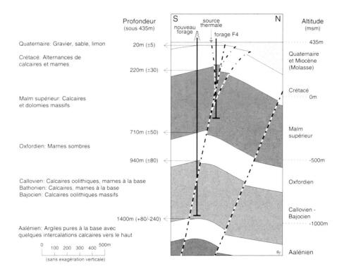
Fig. 10. Coupe géologique prévisionnelle d'un forage profond au Dogger sur le site du Centre thermal à Yverdon-les-Bains.
