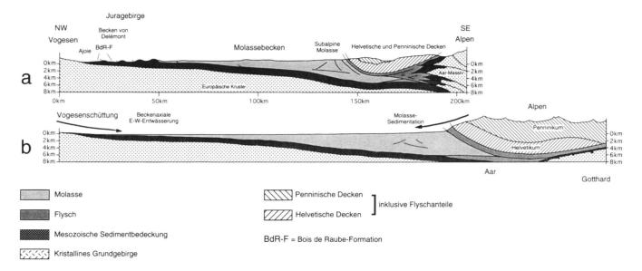
Fig. 2. Schematische NW-SE-Profile durch das zentrale schweizerische Molassebecken.
