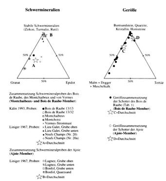
Fig. 6. Geröll- und Schwermineralzusammensetzung innerhalb der Bois de Raube-Formation. Sowohl im Dreieck Schwermineralien als auch im Dreieck Gerölle ist vom Liegenden (Montchaibeux- und Bois de Raube-Member) zum Hangenden (Ajoie-Member) eine Verschiebung zu den stabileren Schwermineralien, respektive Geröllklassen feststellbar.
