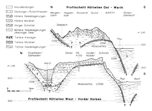
Fig. 2. Typische Profilschnitte westlich und östlich von Hüttwilen ( $10 \times$  überhöht). Lage der Schnitte siehe Figur 1.
