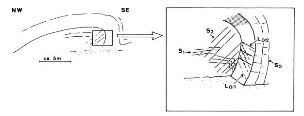
Fig. 2. Südvergente F2-Falte in der Kössen-Formation der Ela-Decke bei Bergün (siehe Stop 3).  $S_0$ : Schichtung,  $S_1$ : erste Schieferung,  $S_2$ : zweite Schieferung,  $L_{0/1}$ : Intersektionslinear zwischen  $S_0$  und  $S_1$ ,  $L_{0/2}$ : entsprechend für  $S_0$  und  $S_2$ .
