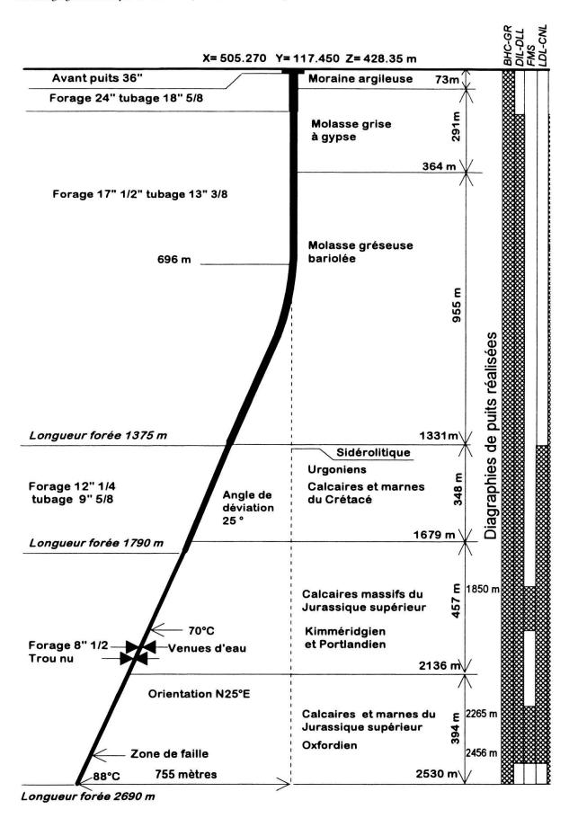
Fig. 5. Géométrie et caractéristiques du forage de Thônex
