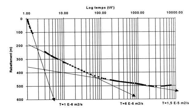
Fig. 11. Evolution du rabattement en fonction du temps observé en période de remontée du niveau de l'eau après l'essai de production en air-lift. T = transmissivité (en m²/s).
