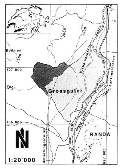
Fig. 1. Lage der Ausbruchnische und des Ablagerungskegels von Randa (vergl. Fig. 11). Verlauf des Umleitungsstollens, sowie des ehemaligen und des heutigen künstlichen Laufes der Vispa.
