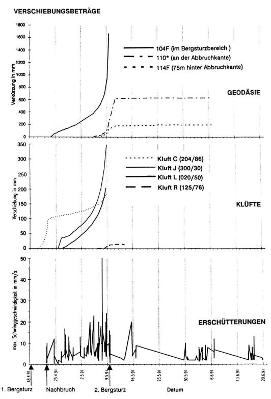
Fig. 8. Vergleich der Resultate verschiedener Messmethoden (Geotest). Oben: geodätische Distanzmessungen, Mitte: einfache Handmessungen über Spalten, unten: Erschütterungsmessungen mit System Vibroguard. In den beiden oberen Feldern kündet sich der Sturz vom 9. Mai 1991 schon mehrere Tage im voraus durch Zunahme der Verschiebungen an. Die Seismometer geben vor und nach dem Sturz zahlreiche Signale, deren Häufigkeit und Amplitude steigert sich aber vor dem Ereignis.
