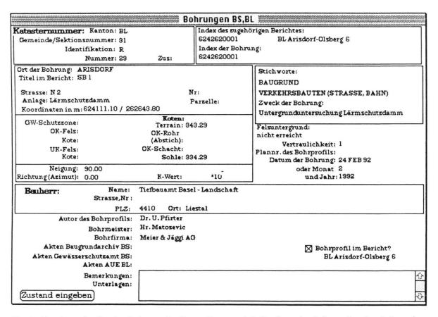
Fig. 6. Eingabemaske für eine Bohrung. In diesem Fenster wird die allgemeine Information (header) zu einer Bohrung eingegeben. Die Stichworte, sowie die Abkürzungen für die Felsformation stammen aus vorgegebenen Listen, welche bei der Dateneingabe in die entsprechenden Felder automatisch am Bildschirm erscheinen.
