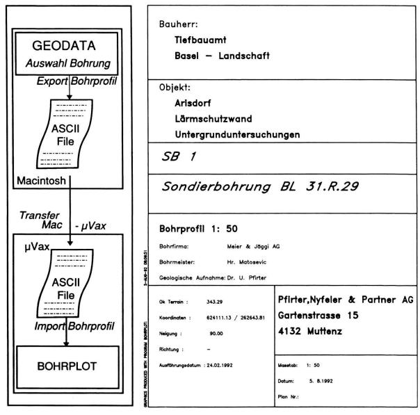
Fig. 9. Beispiel für die Verwendung der Datenbank zum Zeichnen eines Bohrprofils. Die Bohrung wird im Fenster «Bohrung» (Fig. 5) ausgewählt und exportiert. Dieses File wird auf die μVax transferiert und dort vom Programm BOHRPLOT gelesen und gezeichnet.
