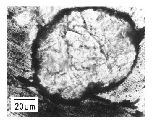
Fig. 7. Lichtmikroskopische Dünnschliffaufnahme eines Einschlusses mit ca. 600facher Vergrösserung. Das Korn zeigt einen komplexen Aufbau mit einem homogenen Kern und einem Saumbereich mit kleinen Kristalliten. Wie Fig. 8 zeigt, kann sich der Saum vom Kern mineralogisch unterscheiden.
