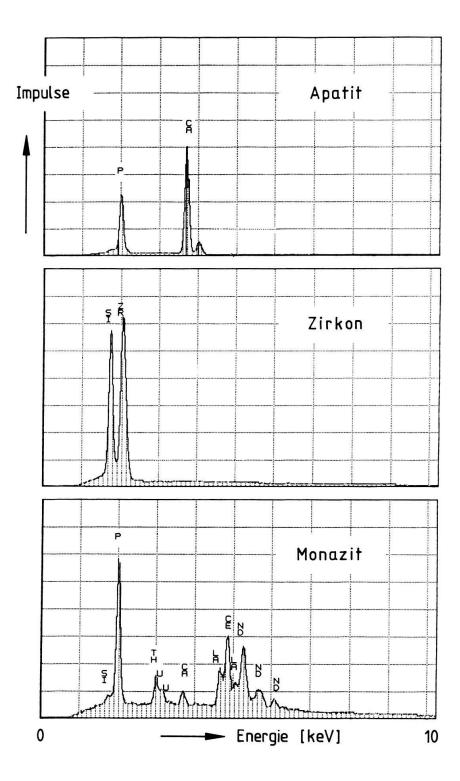
Fig. 6. Mit dem Rasterelektronen-Mikroskop aufgenommene energiedispersive Röntgenspektren von Apatit, Zirkon und Monazit. Sie dienen der sicheren Identifikation der Einschlüsse, die besonders bei lichtmikroskopischer Unterscheidung von Monazit und Zirkon nicht immer eindeutig ist.
