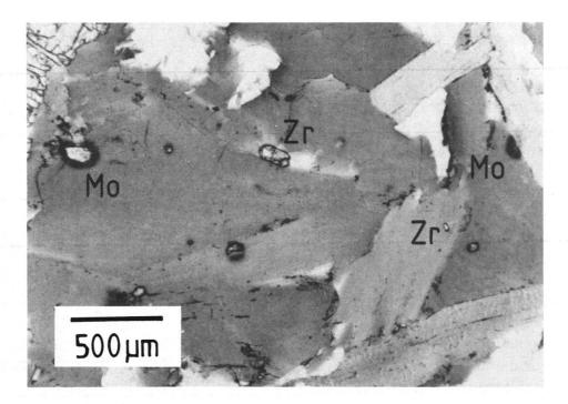
Fig. 3. Lichtmikroskopische Dünnschliffaufnahme einer Probe aus 2300 m Tiefe. Die Zentren der Halos sind Monazite (Mo). Zirkone (Zr) haben in diesem Tiefenbereich keine Halos.
