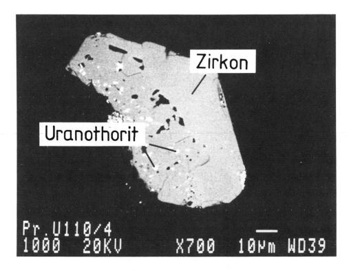
Fig. 9. REM-Rückstreuelektronenbild eines Zirkonkristalls, der von einer Vielzahl sehr kleiner (2–5 μm) Uranothorit-Kristalle durchsetzt ist. Diese verleihen dem Einschluss eine sehr viel höhere Radioaktivität als man bei einem reinen Zirkon erwarten könnte.
