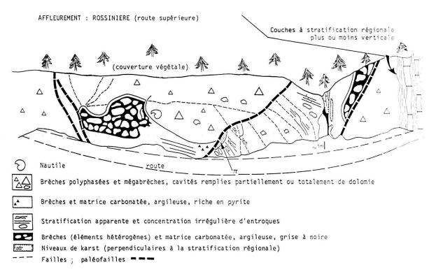
Fig. 7. Rossinière: dessin de l'affleurement avec les faciès particuliers de brèches et mégabrèches avec dyke neptunien (π sur le dessin) rempli de quartz imprégné de goethite, avec figure de slumps.
