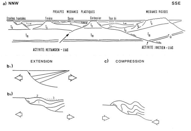
Fig. 10. Modèle (en coupe) du bassin de sédimentation des Préalpes Médianes en rive droite du Rhône au Lias. a) Ls = Lias supérieur; Lm = Lias moyen; Li = Lias inférieur.
