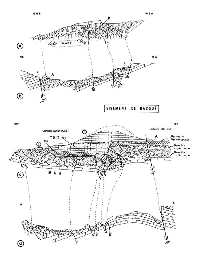
Fig. 5. Coupes géologiques dans le gisement de Bacqué (localisation sur la fig. 4): a-b, gradin sud-est; c-d, gradin nord-ouest. 701, 705, 716, échantillons à palynoflore décrite dans la note; A-B, gisements de mollusques (en majorité gastéropodes).
