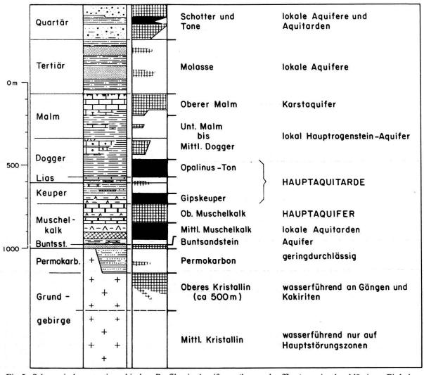
Fig. 2. Schematisches stratigraphisches Profil mit Aquiferen (kreuzschraffiert), geringdurchlässigen Einheiten (weiss) und Aquitarden (schwarz) der Nordschweiz. Nach Diebold (1986), vereinfacht.
