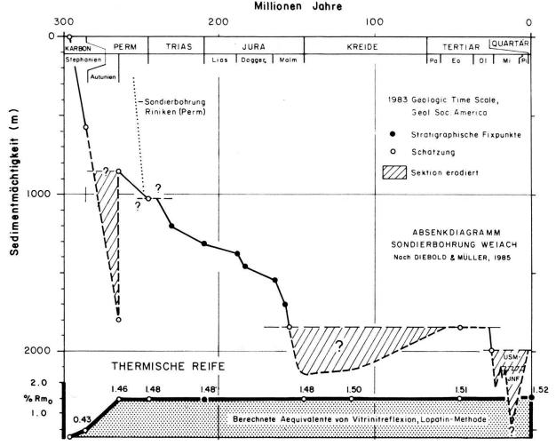
Fig. 2. Zeitliche Entwicklung der thermischen Reife in der Bohrung Weiach nach Modell B, bezogen auf die Basis der Sedimente: Absenkdiagramm nach DIEBOLD & MÜLLER (1985) ergänzt mit 1000 m Paläoversenkung im Perm.
