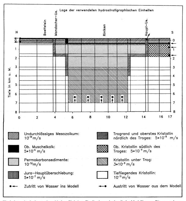
Fig. 3. Lage der hydrostratigraphischen Einheiten für die thermohydraulische Modellierung. Die angegebenen hydraulischen Leitfähigkeiten sind notwendig, um die Modellresultate mit den Feldbeobachtungen in Einklang zu bringen. Die restlichen Randelemente sind undurchlässig.
