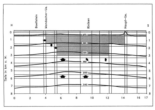
Fig. 4. Berechnetes Temperaturfeld im Bereich des Permokarbon-Troges (dunkel). Bei dieser Berechnung (Details siehe Text) steigt unter dem Trog 2·10<sup>-4</sup> kg Wasser pro sec und m (quer zur Trogachse) auf. Die Richtung der Tiefengrundwasserströmung ist durch Pfeile markiert. Isothermen in °C.
