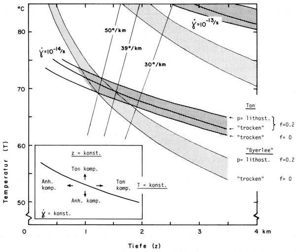
Fig. 4. Darstellung der kritischen Scherrate  $\dot{\gamma}$  (einfache Scherung), bei der Kompetenzumkehr zwischen Ton und Anhydrit eintritt, in Funktion der Tiefe und der Temperatur (dicke Linien). Die resultierende Scherrate erscheint in dieser zweidimensionalen Darstellung als Isolinien, hier für  $\dot{\gamma}=10^{-14}$ , bzw.  $10^{-13}$ /s dargestellt. Für drei spezielle Porendruck(p)-Porositäts (f)-Verhältnisse ist jeweils eine Kurve gezeichnet (siehe Text).
