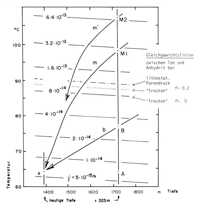
Fig. 5. Diagramm für die kritische Scherrate, bei der Kompetenzumkehr zwischen Ton und Anhydrit eintritt, entsprechend Fig. 4, hier speziell angewandt auf den Kern in Fig. 1b. Isolinien in Verdoppelungsschritten. Für die 8·10<sup>-14</sup>/sec-Isolinie sind die Abweichungen bei 20% Porosität und fehlendem, resp. lithostatischem Porendruck aufgezeichnet. Entsprechende Abweichungen gelten auch für die übrigen Isolinien.
