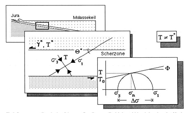
Fig. 3. Spannungsverteilung in einer Scherzone: Grundlage zum Festigkeitsvergleich zwischen einem kataklastischen und einem kristallplastischen Material. Die Variablen ohne Stern-Indizierung beziehen sich auf die Spannungsverteilung innerhalb der Scherzone, die mit Sternen indizierten auf Spannungen und Scherbewegungen parallel zur Scherzone (weitere Erläuterungen siehe Text).
