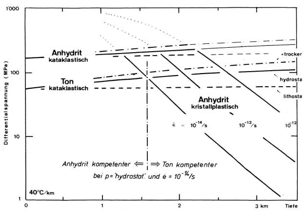
Fig. 2. Das Verformungsverhalten in reiner Scherung von Anhydrit und Ton als Funktion der Tiefe unter Annahme eines geothermischen Gradienten von 40 °C/km und eines durchschnittl. spez. Gewichtes der überlagernden Gesteinssäulen von 2,5 g/cm<sup>3</sup>. Die Porendruckangaben basieren auf einer kataklastischen Festigkeitsformel, die die Porsität nicht berücksichtigt.
