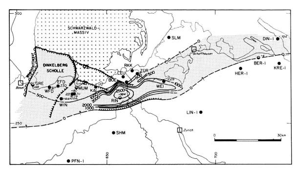
Fig. 1. Nordschweizer Permokarbon-Trog mit Isopachen des Permokarbons. Konstruiert aufgrund der Reflexionsseismik (Fig. 28 und 29 in Sprecher & Müller 1986) und Mächtigkeitsangaben aus Bohrungen.
