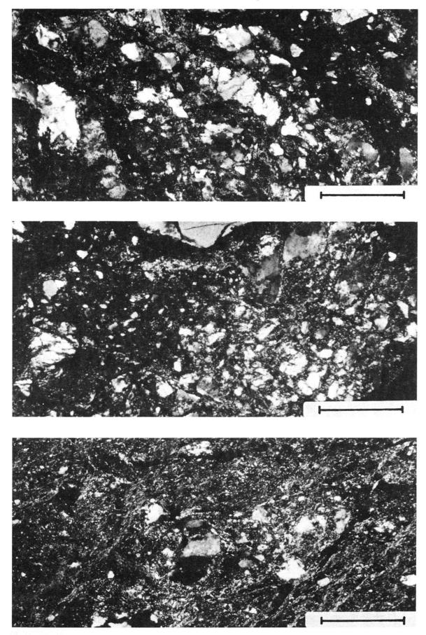
$Fig. 2. \ Progressive \ Kataklase: Protokataklasit - Kataklasit - Ultrakataklasit. \ Kontakt \ Erstfelder/Innertkirchner \ Kristallin, Grätli, Sustenpass (BE). \ Maßstab = 0,5 \ mm.$
