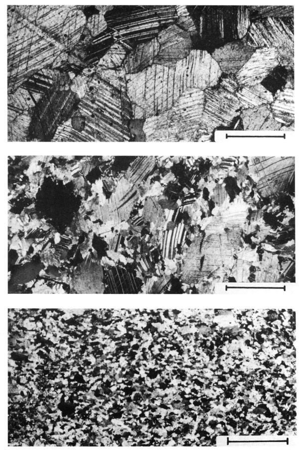
$\label{eq:continuous} Fig. 6. \ Progressive \ Mylonitisierung in einem \ Marmor: \ Undeformierter \ Marmor - Calcit-Protomylonit - Calcit-Mylonit. \ Castione-Traversagna-Zug, \ V. \ Traversagna \ (GR). \ Maßstab = 0,5 \ mm.$
