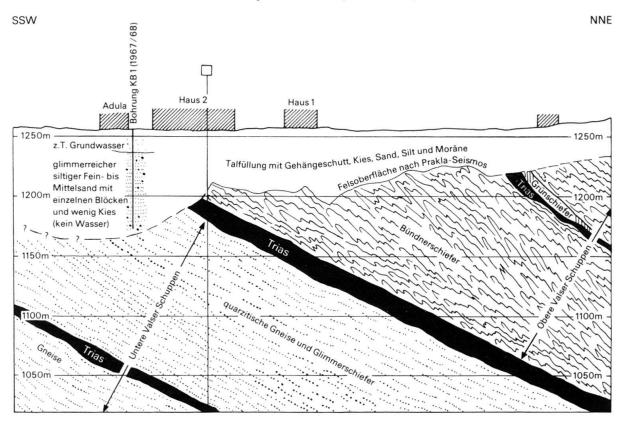
Fig. 5. Geologisches Profil parallel zur Richtung des Valser Rheins durch den Untergrund des Kurhotelareals (= Trasse b auf Fig. 2 und 3). Nicht überhöht.
