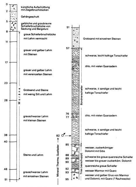
Fig. 1. Profil der Neubohrung 1980 (Spülbohrung) der mineralisierten Thermalquelle von Vals (733.410/164.910/1280 m), rekonstruiert aus den Gesteinssplittern, die nach jedem Meter entnommen wurden.
