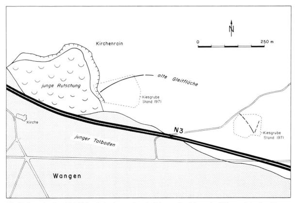
Fig. 10. Lage der alten Gleitflächen in Lockergestein nahe Wangen, Kt. Schwyz, im Südwestteil des Buechbergs.
