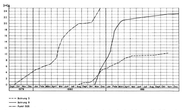
Fig. 14. Horizontalverschiebungen nahe dem Kerenzerbergtunnel während und nach dem Bau. Oberflächenpunkt 505 und Slope Indicators in den Bohrungen 3 und 9 (Lage siehe Figur 12).
