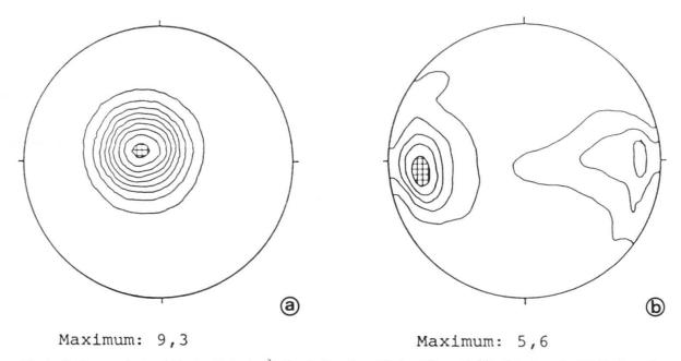
Fig. 4. Polfiguren konsolidierter (1 kp/cm²) Kaolinitproben (China Clay, Ca<sup>++</sup>) (Maxima in Vielfachen der uniformen Verteilung). a: senkrecht  $\sigma_1$ , b: parallel  $\sigma_1$ .
