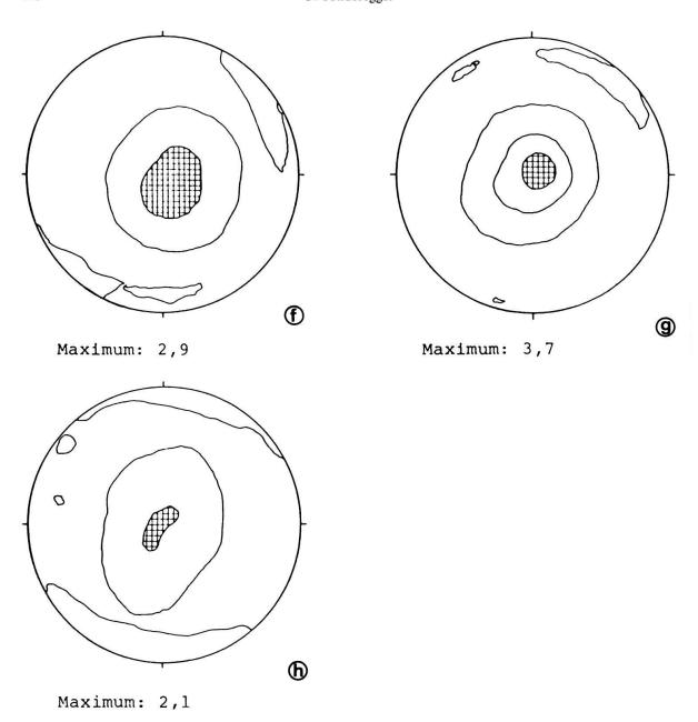
Fig. 8. a: 1-kp/cm<sup>2</sup>-konsolidierte Kaolinitprobe (KGa-1 well, Ca<sup>++</sup>). b-h: Profil durch die gescherte KGa-1-well-Probe (Maxima in Vielfachen der uniformen Verteilung).
