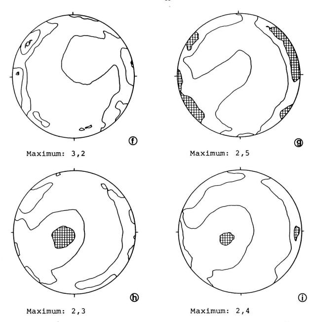
Fig. 7. a: 1-kp/cm²-konsolidierte Kaolinit-Quarz-Probe (CCCQ30 = 70 Trockengew.-% China Clay Ca<sup>++</sup> + 30 Trockengew.-% Quarz < 63 μm). b-i: Profil durch die gescherte CCCQ30-Probe (Maxima in Vielfachen der uniformen Verteilung).
