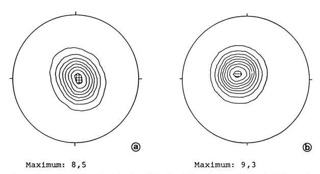
Fig. 6. Polfiguren konsolidierter Kaolinitproben (China Clay Ca<sup>++</sup>) senkrecht  $\sigma_1$  (Maxima in Vielfachen der uniformen Verteilung). a: 0,5 kp/cm<sup>2</sup>, b: 1,0 kp/cm<sup>2</sup>.
