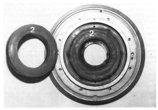
Fig. 3. Gescherte Montmorillonit-Probe (SAz-1, Li<sup>+</sup>), diskrete Scherfläche (2) sichtbar.
