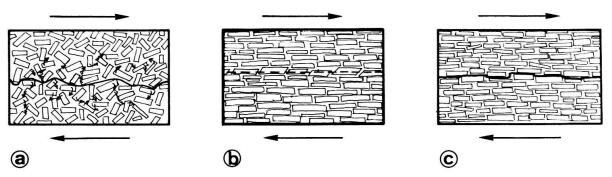
Fig. 11. Schematische Darstellung der Teilchenbewegung während des Schervorganges.
