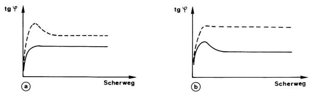
Fig. 10. Stabile (ausgezogene) und metastabile (gestrichelte) Scherkurven (siehe Text).
