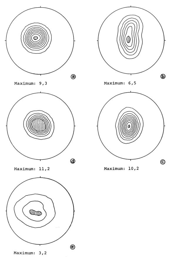
Fig. 5. Polfiguren konsolidierter (1 kp/cm²) Kaolinitproben senkrecht σ<sub>1</sub> (Maxima in Vielfachen der uniformen Verteilung). a: China Clay, Ca<sup>++</sup>, carbowachsimprägniert, b: China Clay, carbowachsimprägniert, c: China Clay, kunststoffimprägniert, d: CCCQ30, kunststoffimprägniert (70 Trockengew.-% China Clay Ca<sup>++</sup> + 30 Trockengew.-% Quarz < 63 μm), e: KGa-1 well, Ca<sup>++</sup>, kunststoffimprägniert.
