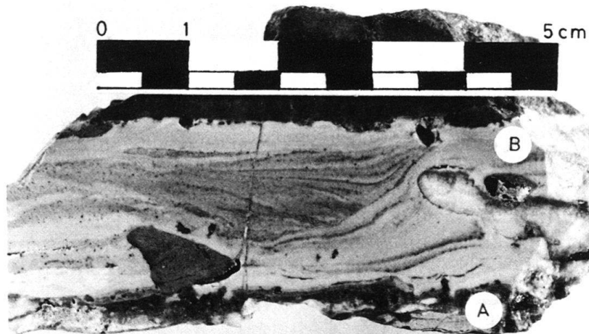
Fig. 7. Filon de calcilutite jaune ocre avec laminations montrant l'influence de fragments grossiers sur la géométrie des structures (B). La base du filon est formée de brèche à éléments de dolomite très calcitisée blanche dans un ciment de calcite riche en hydroxydes de fer de couleur orange (A).
