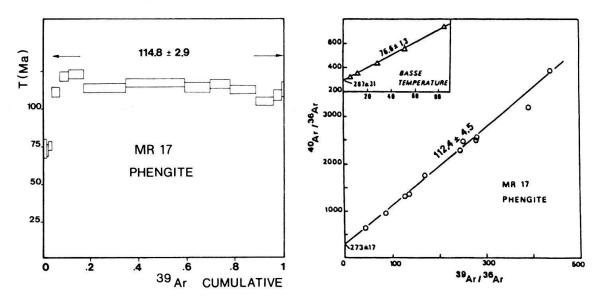
Fig. 6. Spectre d'âges et diagramme isochrone pour les phengites MR 17 des micaschistes pélitiques de la haute vallée d'Ayas. Deux groupes d'âges principaux sont mis en évidence: un âge plateau à 114,8 ± 2,9 Ma, associé au métamorphisme de très haute pression, et un groupe d'âges de basse température à 60-75 Ma qui traduit une perturbation du système isotopique. Sa signification possible a été discutée précédemment (Chopin & Monié 1984).
