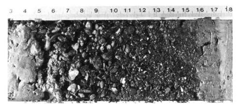
Fig. 8. Kiesige Zwischenschicht in den überwiegend feinkörnig aufgebauten Sedimenten der zentralen See-Ebene. Solche Einschaltungen können als Folge von murgangartigen Ereignissen in den seitlich einmündenden Wildbächen interpretiert werden (cm-Maßstab).
