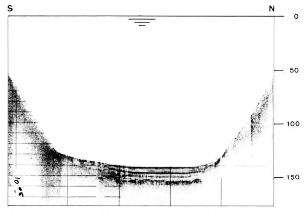
Fig. 3. Querprofil des Walensees zwischen Murg (Süd) und Quinten (Nord) (4,5-kHz-mud-penetrator). Im zentralen Teil erkennt man deutlich geschichtete Sedimente, welche an den Beckenrändern in die seismisch undurchsichtigen Bachkegelschüttungen übergehen. Tiefenangabe in Metern.
