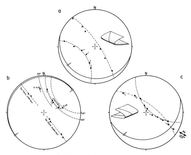
Fig. 8. Reprise par P<sub>3</sub> de linéations antérieures. a: cas par flexion; b: cas intermédiaire; c: cas par glissement. Légende des symboles à la figure 6. DG: direction de glissement.
