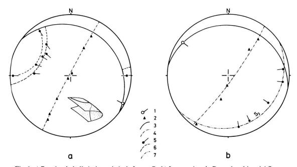
Fig. 6. a) Reprise de la linéation minérale L<sub>1</sub> par P<sub>2</sub>. b) Intersection de P<sub>2</sub> par la schistosité S<sub>3</sub>. 1: axe; 2: pôle de S<sub>0</sub>; 3: surface axiale; 4: enveloppe du pli; 5: linéation; 6: petit cercle; 7: grand cercle. Canevas de Wulff, hémisphère supérieur.
