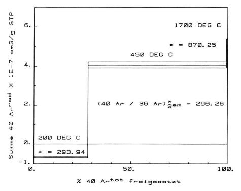
Fig. 4. Stilpnomelan 1-13/08: Entgasungsexperiment mit drei Temperaturschritten (200 °C, 450 °C, 1700 °C). Die Fehlerbalken zeigen den Fehler im <sup>40</sup>Ar<sup>rad</sup> des Einzelsteps, errechnet aus der jeweiligen Regressionsanalyse von acht Ablesungen pro Isotop (36,40).
