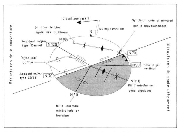
Fig. 3. Schéma récapitulant le jeu atlasique des anciens accidents de socle (encadrés sur la figure) réactivés et les structures formées lors de la compression atlasique.
