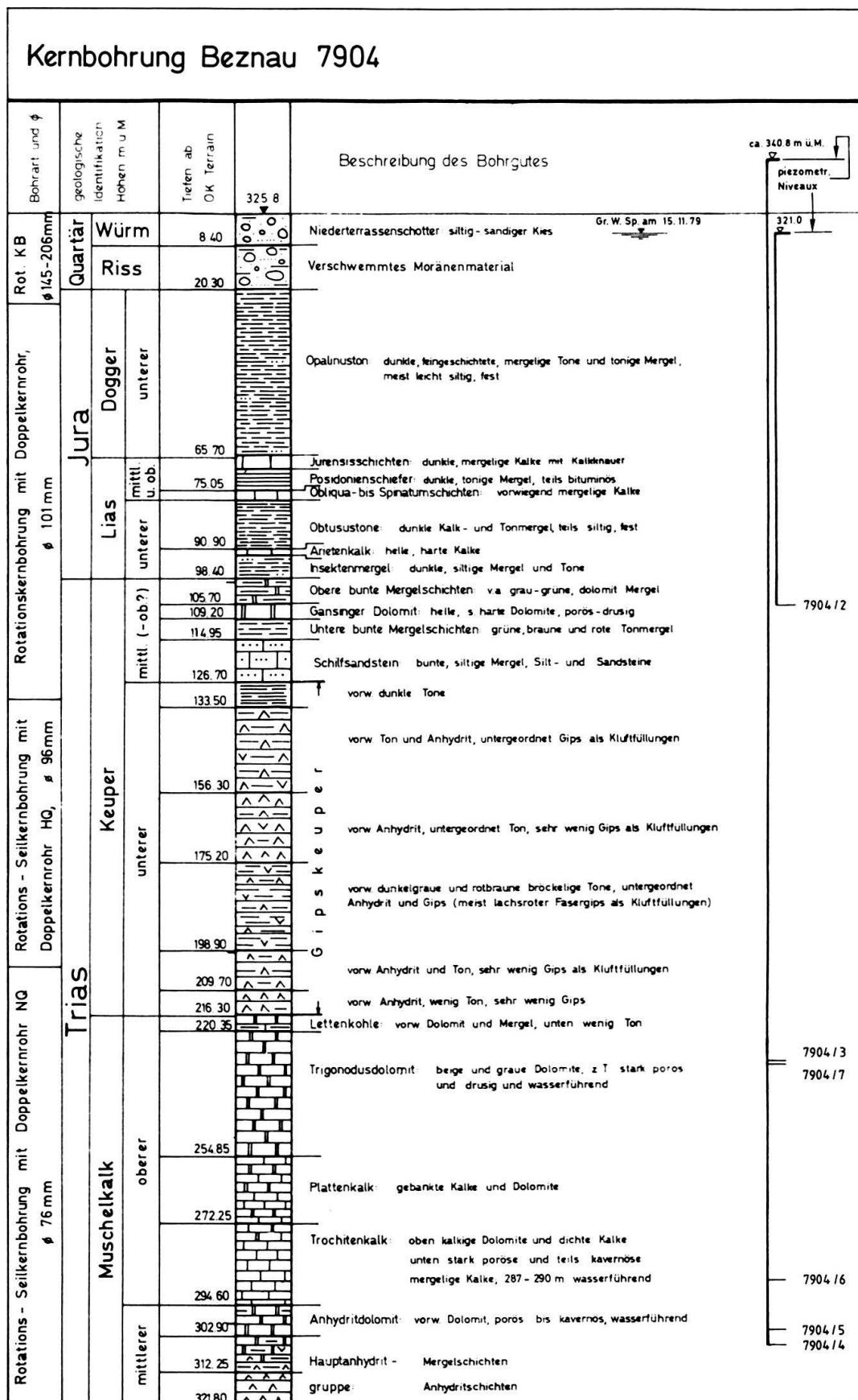
Fig. 2. Lithologisches Sammelprofil der Kernbohrung Beznau 7904 (1:2000).
