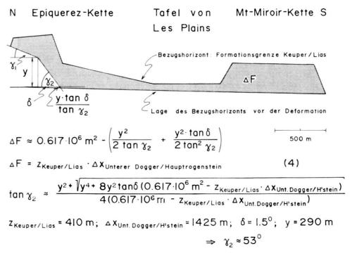
Fig. 6. Berechnung der Steigung der Epiquerez-Überschiebung für den Bereich zwischen der undeformierten Formationsgrenze Keuper/Lias und der nördlichen Axialebene des Südschenkels der Epiquerez-Kette. Erläuterungen im Text.
