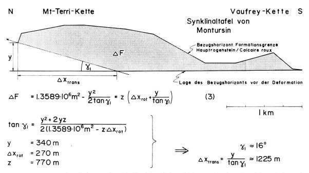
Fig. 3. Berechnung der Steigung der Mt-Terri-Randüberschiebung für den Bereich zwischen der undeformierten Formationsgrenze Hauptrogenstein/Calcaire roux und demselben Horizont des Hangenden. Erläuterungen im Text.
