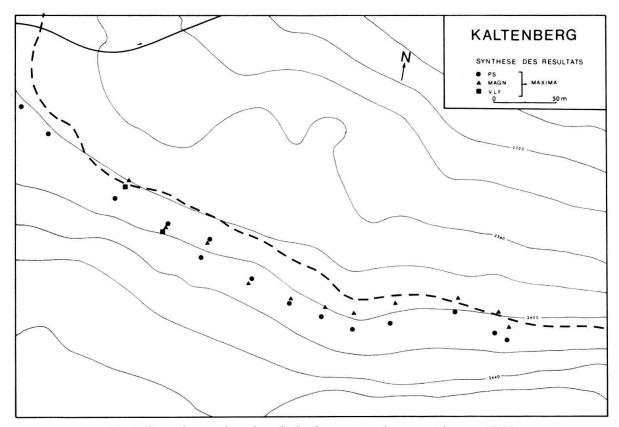
Fig. 7. Carte des maxima de polarisation spontanée, magnétisme et VLF.
