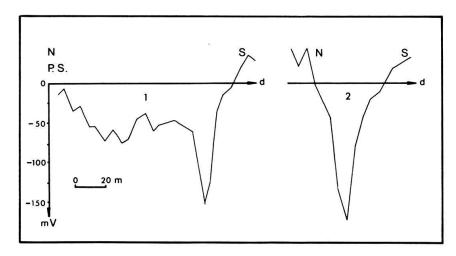
Fig. 3. Exemples de profils de polarisation spontanée.
