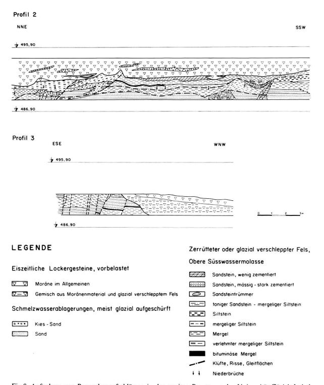
Fig. 8. Aufnahme von Baugrubenaufschlüssen in der zweiten Bauetappe der Universität Zürich-Irchel (V. Longo).
