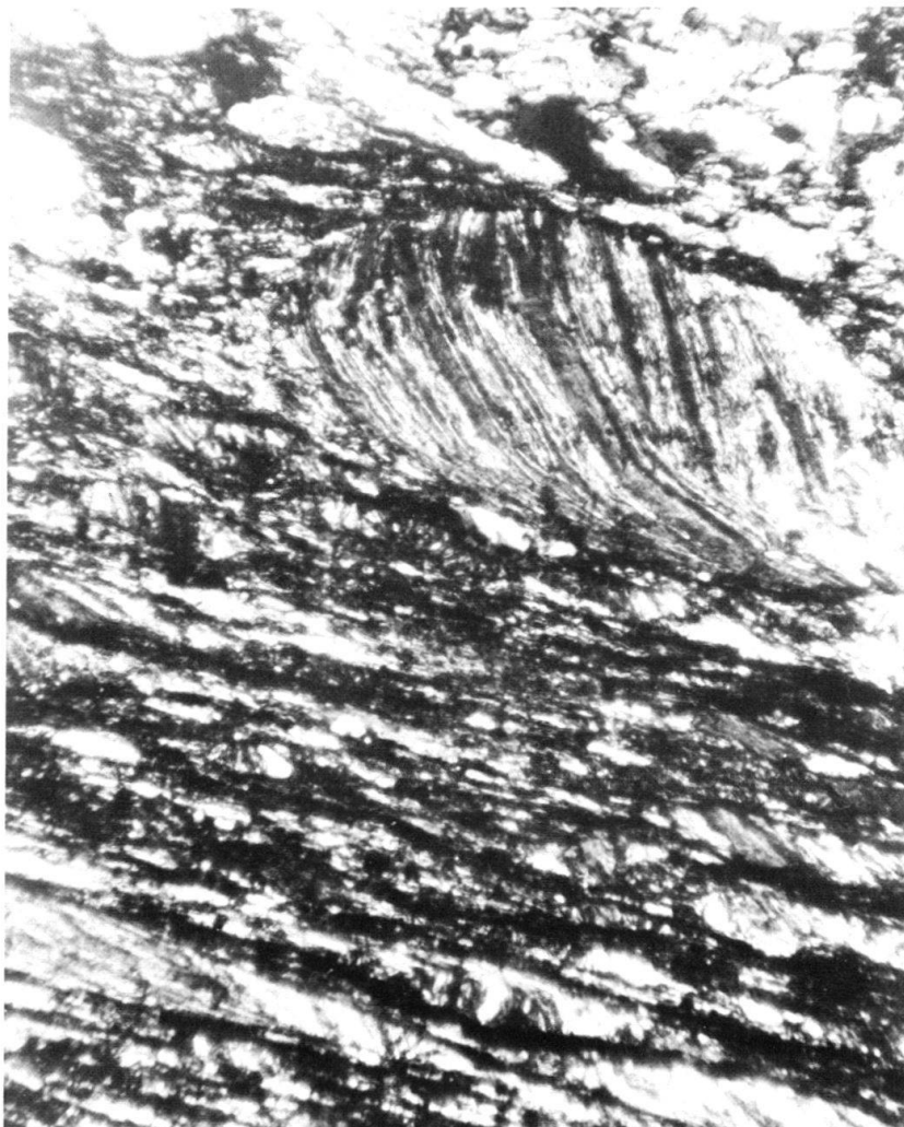
Fig. 18. Textures dans les semi-pélites de la zone Martigny–Chamonix. Agrégats chlorite–illite dont l'origine et l'orientation moyenne sont liées au stade sédimentaire. Il s'agit donc d'une structure relique, anté-tectonique. Longueur moyenne des grands agrégats: 0,5 mm.
