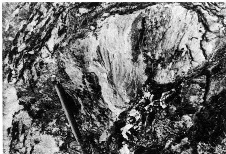
Fig. 13. Déformation de la linéation l_1 . Linéation l_1 déformée dans un plan ou dans une succession de plans parallèles S_1 très rapprochés, vraisemblablement durant la 2 e phase de déformation. Urgonien et terrains divers de la suture médiane. Sur-le-Sceux au-dessus de La Bâtière.
