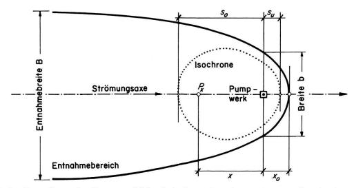
Graphische Darstellung des Strömungsbildes bei einem Grundwasser-Pumpwerk, mit eingetragenen Bezugsgrössen zu den Formeln (2) und (10).
