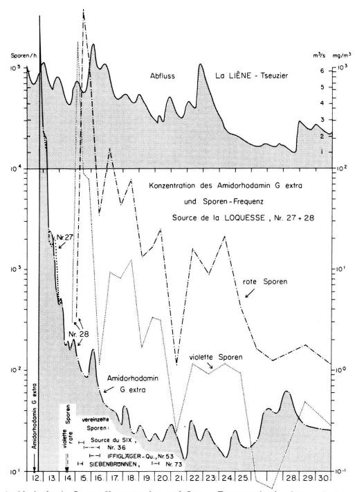
Fig. 5. Amidorhodamin-G-extra-Konzentration und Sporen-Frequenz in der Source de la Loquesse sowie Abfluss der Liène bei Tseuzier vom 12. bis 30. August 1975.
